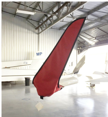
Schleicher ASH Wingtip Pads
